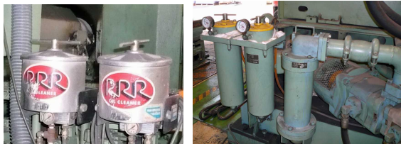
↓ R社バイパスフィルターと、↓ 東芝純正オ フラインフィルターはバルブを閉じて不使用 (ラインフィルターも交換なし)
